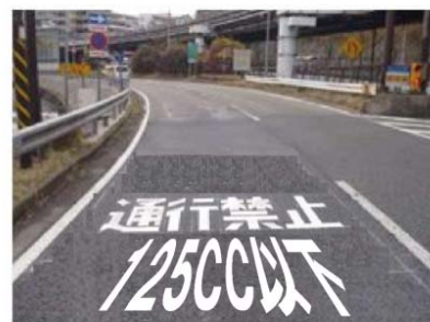
IC 入口部の路肩に設置した進入禁止ポール、進入禁止看板、通行禁止路面標示
