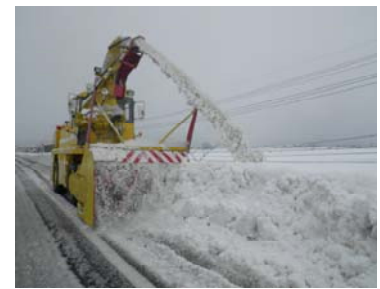
雪氷対策作業状況(路肩除雪)
